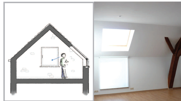
Les pièces de vie dans les combles disposent de baies droites dans les murs ou de fenêtres de toit permettant des vues vers l'extérieur
